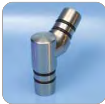
*F500-16 AISI 304 Esmerilado | 42,4 mm x 45° Angulo ajustable 5°
