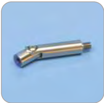
*F500-24 AISI 304 Esmerilado 14 mm L 68 mm y M6 z M8
