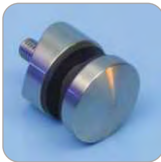
*F500-26/B AISI 304 Esmerilado Sujeción de cristales Ajustable a cristales de 6 / 8 / 10 / 12 mm Ø 30 mm - M8 para Tubo de 42,4 Agujero en el vidrio Ø 14 mm
