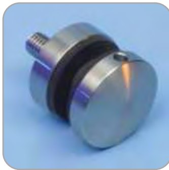
*F500-27/B AISI 304 Esmerilado Sujeción de cristales Ajustable a cristales de 6 / 8 / 10 / 12 mm Ø 30 mm - M8 Agujero en el vidrio Ø 14 mm
