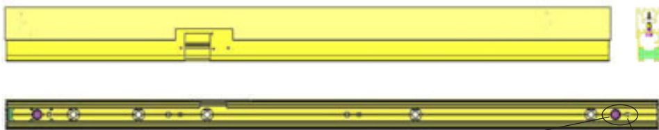
FIGURA 7. Perfil Marco Superior con Expansor A. Tornillo de regulación en altura B. Tornillo de bloqueo
