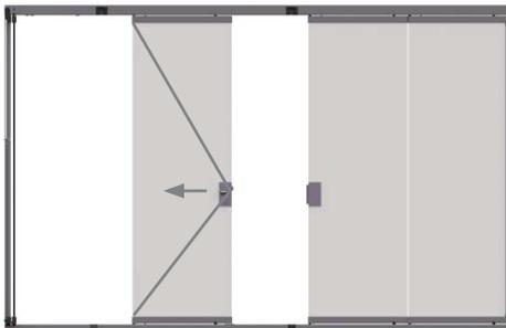
La puerta activa de paso puede ser situada en cualquier parte central del sistema, siendo accionada mediante cerradura como en cualquier sistema seeglass convencional.
