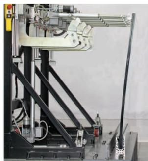
Déformation sous charge 3KN/m
