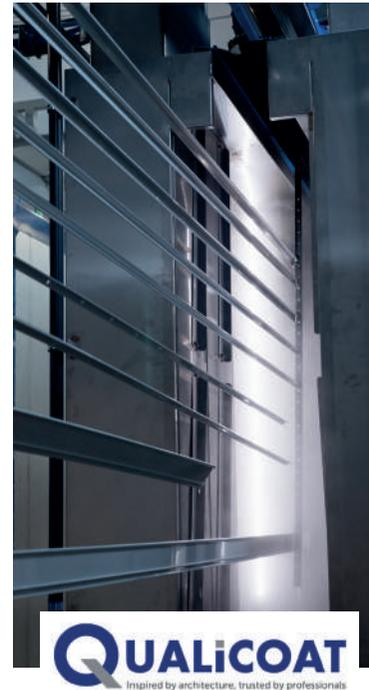
Ai nostri nuovi stabilimenti abbiamo aggiunto un avanzato impianto di verniciatura a polvere multimetallo, progettato per applicare finiture di alta qualità a profili in alluminio e altri accessori metallici. Questo impianto è conforme agli standard internazionali più esigenti, tra cui Qualicoat, Qualicoat Seaside e Qualimarine.
