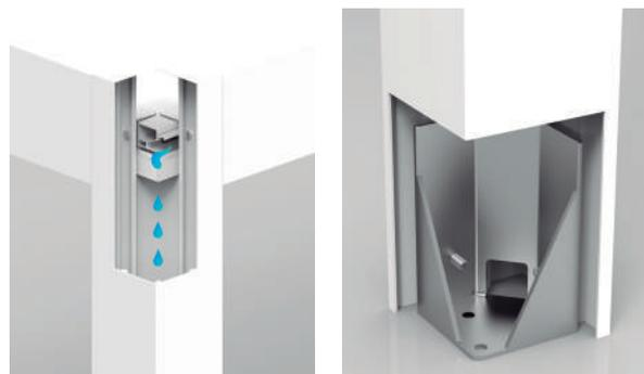
ESEMPIO SISTEMA DI SCARICO LIBERO e SUPPORTO INFERIORE DEL PILASTRO (Fig. A)
