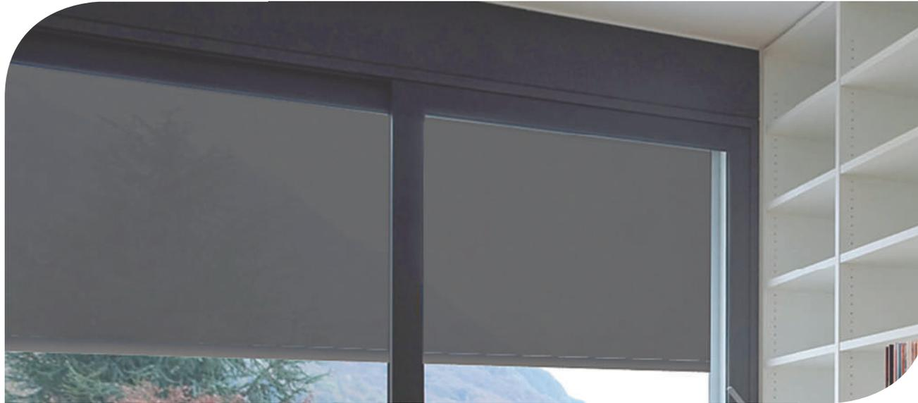
Die Screen- Markise **Habitat ZIP** von **C3 Systems** besteht aus einem Aufrollsystem mit einer Kassette, die einen geschweißten Reißverschluss an den Seiten des Tuchs sowie ein Federsystem an den Seitenführungen aufweist, das eine größere Spannung als bei herkömmlichen Systemen bietet und die Abdeckung großer Flächen ermöglicht.
